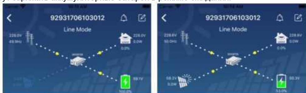
**[Battery Mode] (Режим батареи)** Инвертор подает питание на нагрузку от аккумуляторных батарей с подмешиванием энергии от солнечных батарей. Заряжать батареи в данном режиме возможно только от солнечных батарей.
