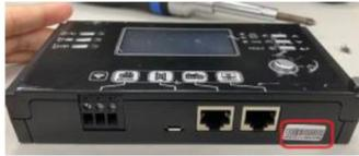
Данная этикетка с номером устройства приклеена к нижней части дистанционной жидкокристаллической панели.
