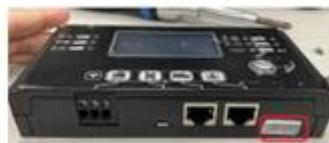
Наклейка с PN номером размещена на нижней части контрольной панели инвертора
